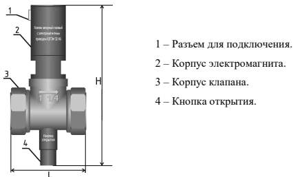
Рисунок 3. – Клапан КЗГЭМ-Б.
