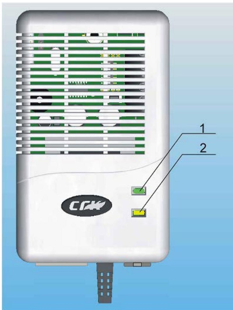
Рис. А.1. – Сигнализатор загазованности природным газом СЗ-1, СЗ-2.
