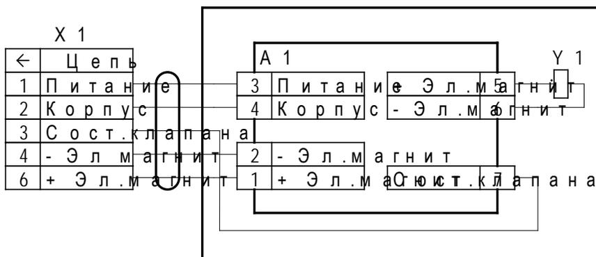
Рис. Г1. Назначение контактов разъема у клапанов (СД) с разъемом РГ -17.
