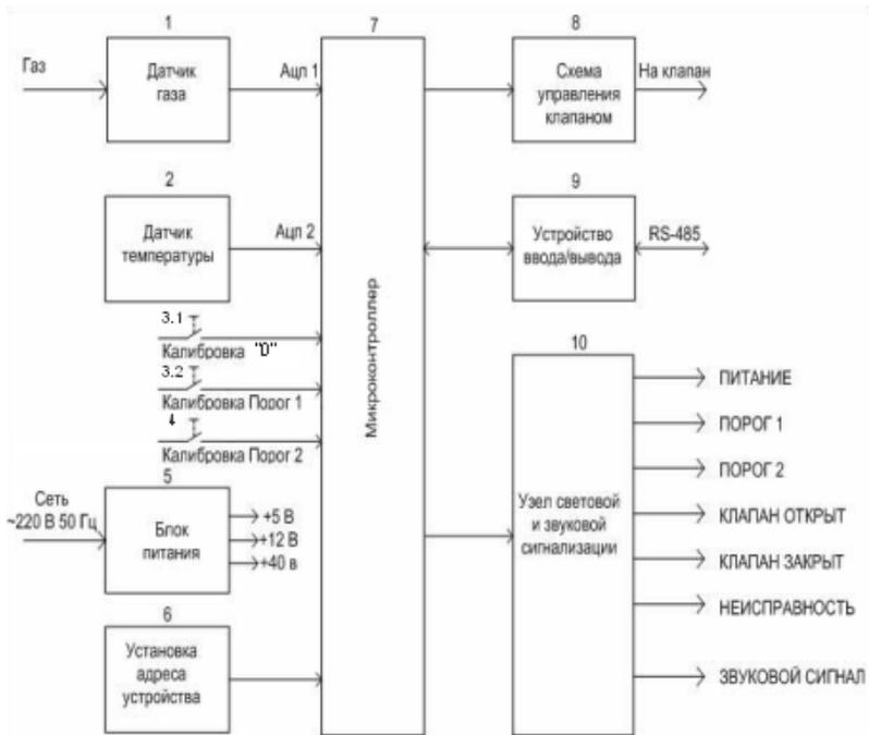
Рис. Б. 1. – Сигнализатор загазованности. Схема структурная.
