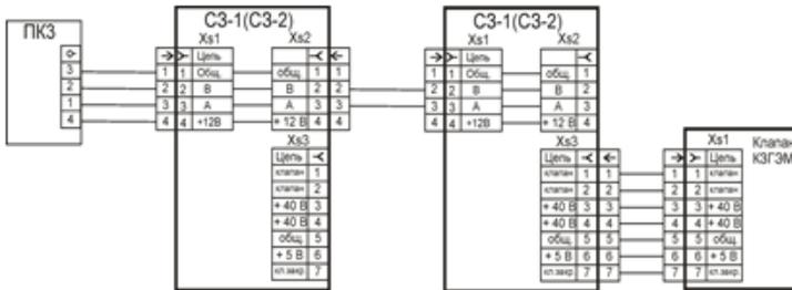
Рис. Б.3. –Сигнализаторы СЗ-х. с разъёмами RJ-45 и RJ-12.
