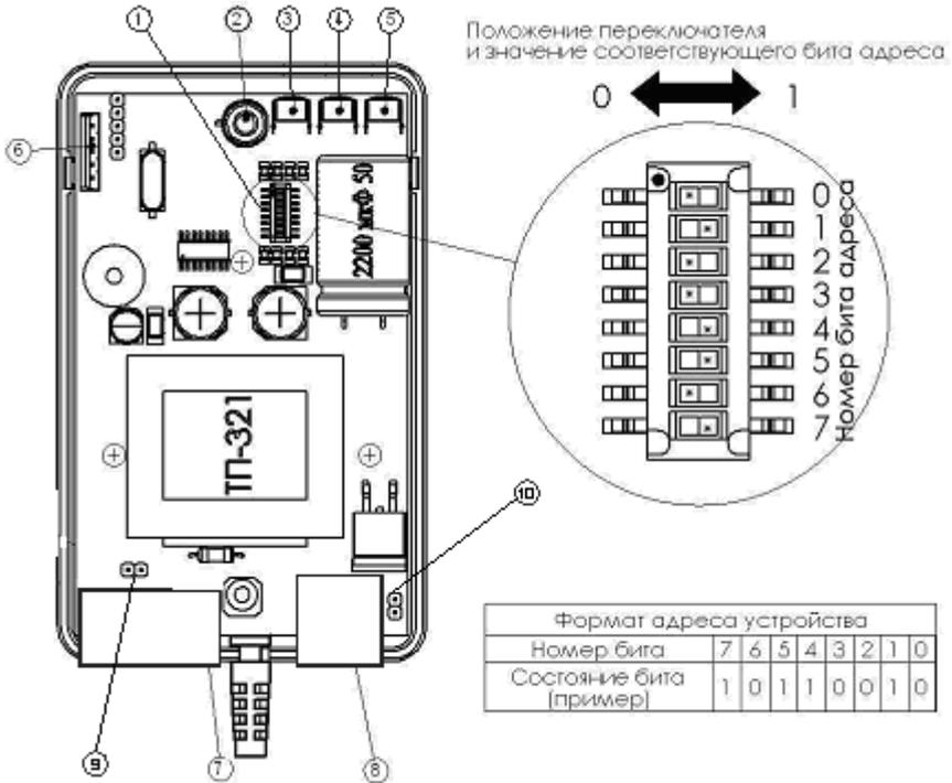
Рис А. 2 – Сигнализатор загазованности СЗ-х.
