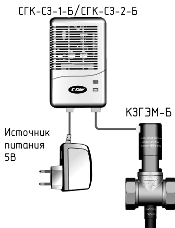
Рис. 1. Сигнализаторы SGK-C3-x-B с клапаном типа KZGEM-B.
